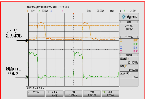
図7-7：パルス幅10ns:周波数10MHzでの発振例。
