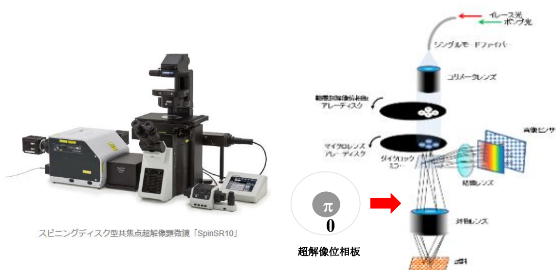
図 12-1：3次元超解像顕微鏡法のスキャンディスク型のレーザー走査型顕微鏡への応用。
