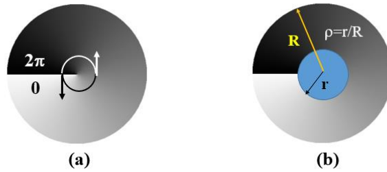
図 4－18： ラゲール・ガウシアン型位相分布をもつイレース光にアポタイゼーションを施した時のシミュレーションモデル。(a)通常のラゲール・ガウシアン型位相分布。(b) 瞳半径 R において半径 r のアポタイゼーションを行ったときの位相分布。
