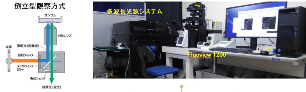
図7-4：3次元超解像顕微鏡装置の概観写真。
