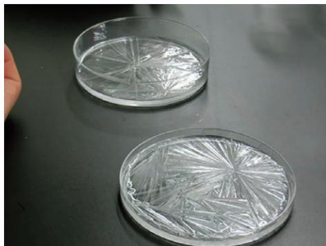
図4.酢酸ナトリウムの実験
