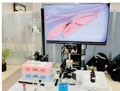
写真10 デジカメを用いた顕微鏡投影機
