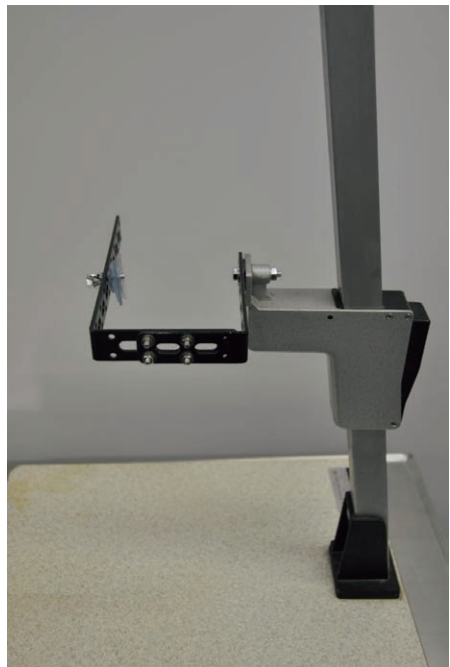
写真1 カメラ取り付け装置1
