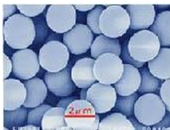
Figure 4. 従来のシリカ充填型カラムの構造 (引用 : Imtakt HP)
