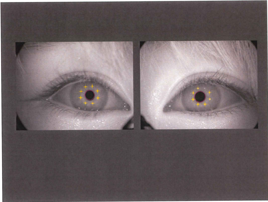
図 4. 角膜反射法と瞳孔中心法による視線情報の取得
