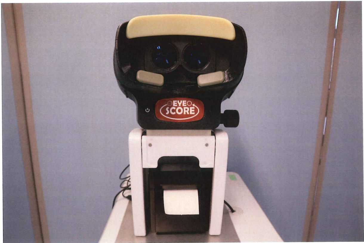
図 1. 眼球運動測定装置 (EyeScore)
